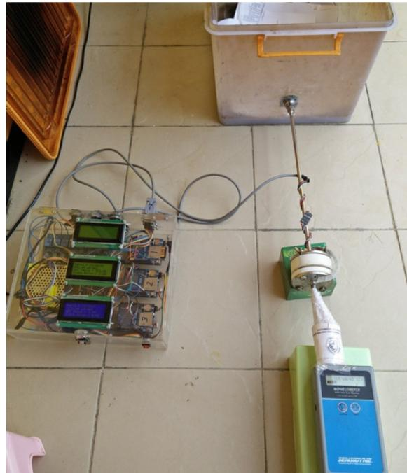
Gambar 10. Konstruksi Kalibrasi SHARP GP2Y1010
