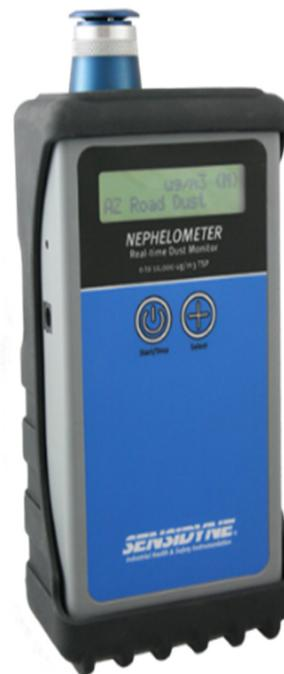
Gambar 5. Alat Referensi Pembacaan Partikulat Sensidyne Nephelometer
